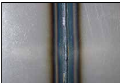
■ Staal stompe las PG | 2,0 mm FOCUS.ROOT
