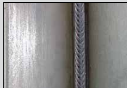
■ CrNi hoeklas PF | 5,0 mm POWER.PULS (als dubbelpuls)
