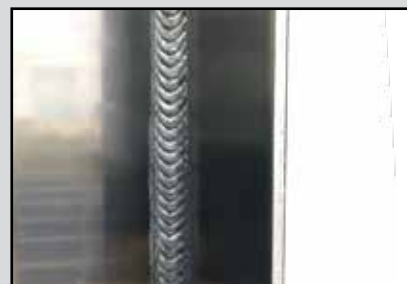
■ Aluminium hoeklas PF | 3,0 mm POWER.PULS (als dubbelpuls)
