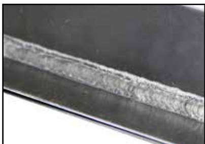
■ Aluminium hoeklas PB | 1,5 mm POWER.ARC
