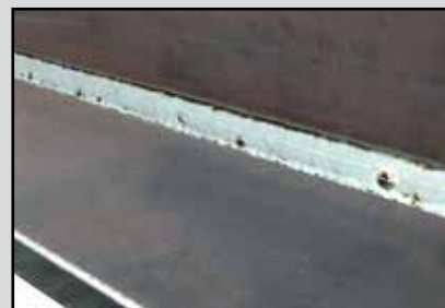
■ Staal hoeklas PB | 10,0 mm FOCUS.ARC
