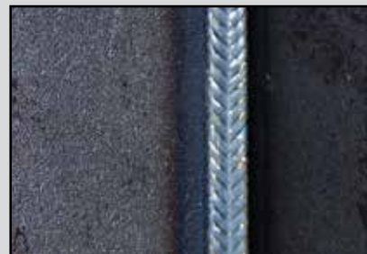
■ Stahl hoeklas PF | 5,0 mm POWER.PULS (als dubbelpuls)
