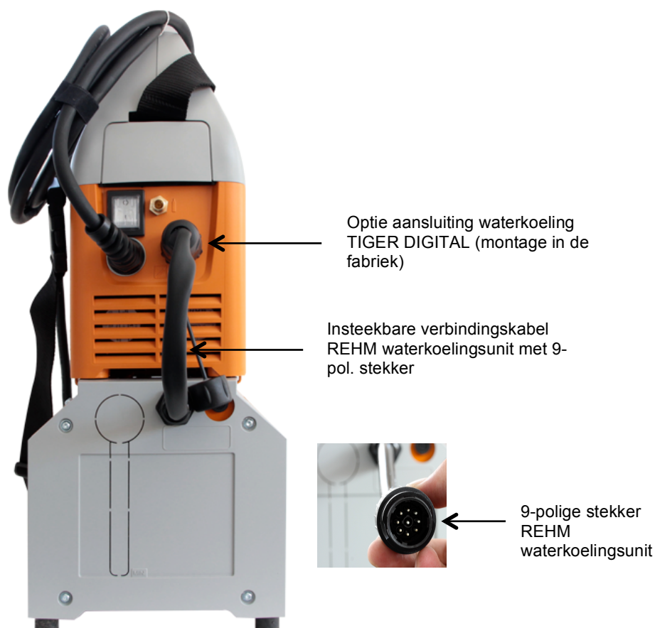
Afb.27 TIGER DIGITAL met optie waterkoeling en aansluiting koelsysteem / achteraanzicht
